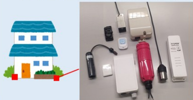
実証実験に用いている浸水センサ
