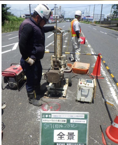
(左上) ドローンによる目視調査 (左下) リバウンドハンマーによる打音調査等 (右下) 貫入試験による空洞調査
