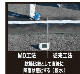
MD工法 従来工法 超速乾 1~2分後の乾燥性比較
