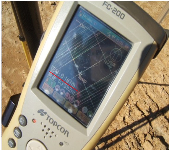
写真① キャビン内で確認できる設計面との差異
