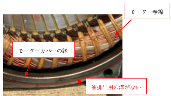
写真12 モーターカバー裏側拡大 (上写真は事故機と同型機のもの)
