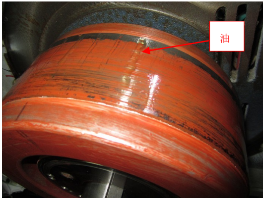
写真8 モーターローター油付着状況 (モーターカバーを外した状態)
