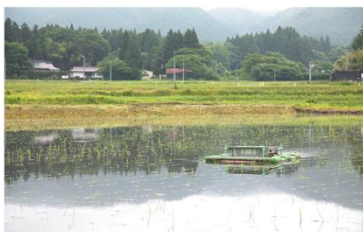
①自動抑草ロボット 泥を巻き上げて、雑草の発生を抑制するロボット
