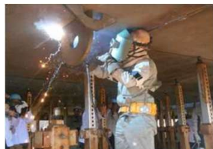
手作業による溶接工程
