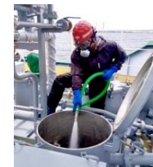
従来の「手動」による スロップタンク洗浄作業
