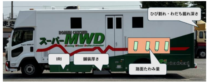
<掲載技術名>ロメンキャッチャースーパー-MWD (検出項目:ひび割れ率、わだち掘れ量、IRI)
