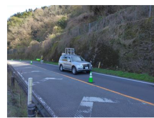
MMS※1を活用した 斜面・のり面点検
