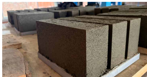
バングラデシュにおいて塩分を含む浚渫土等を使って製造した無焼成レンガ（乾燥工程中）。
