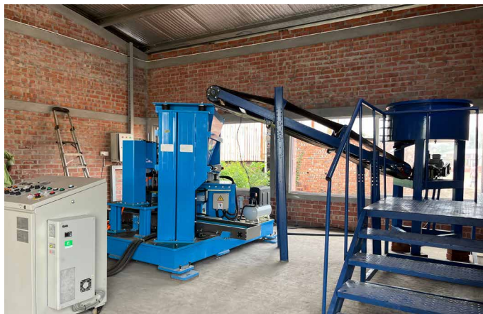
バングラデシュに導入した無焼成レンガ製造機（日本製）。機械上部の投入口に混練後の原料を流し、自動で成型口に落下する。成型口に入った原料は上から圧をかけ成型する。
