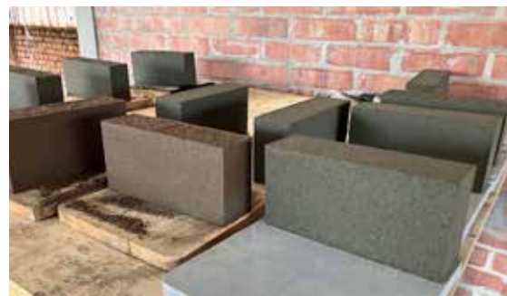
海水・海砂ならびに当社が開発した無機質混和材を使用し、製造した無焼成レンガ。
