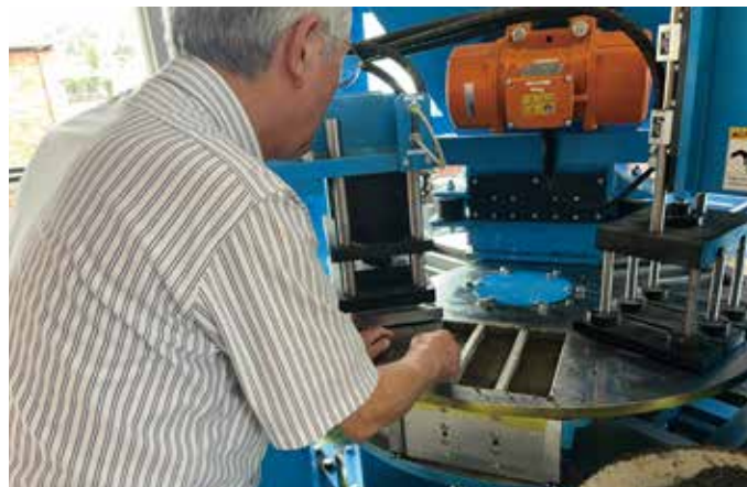
複数のパターンのレシピごとに設定された圧力値の数値を確認中。圧が均等にかかることで強度の発現につながる。この作業は数百回にわたる。
