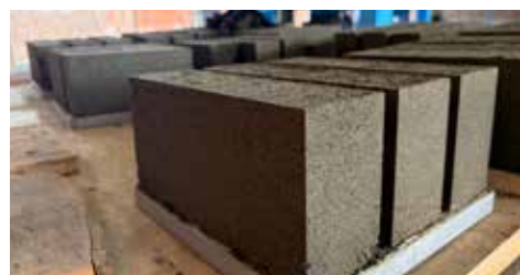
Bangladeshにおいて塩分を含む浚渫土等を使って製造した無焼成レンガ（乾燥工程中）。
