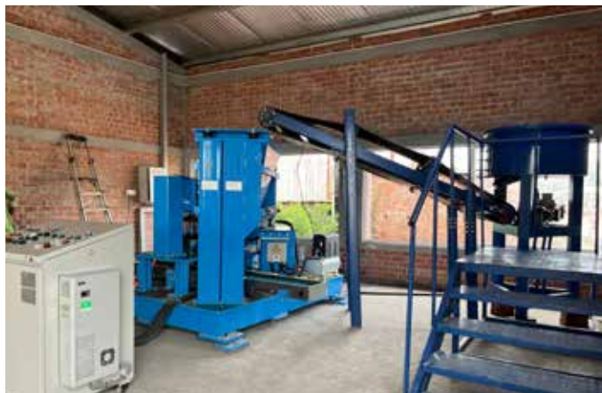
Bangladeshに導入した無焼成レンガ製造機（日本製）。機械上部の投入口に混練後の原料を流し、自動で成型口に落下する。成型口に入った原料は上から圧をかけ成型する。
