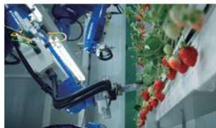
ロボットが完熟したタイミングを見極め、自動で収穫を行う。
