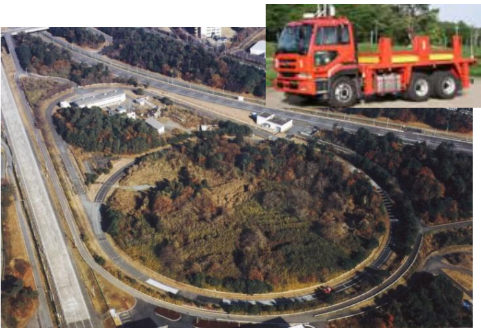
実大の供試体による促進載荷試験
