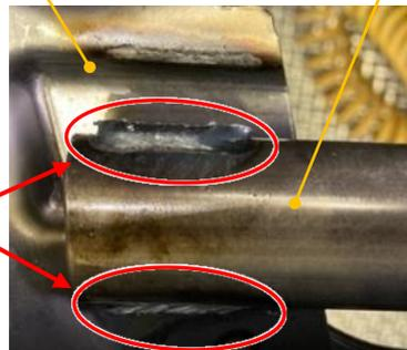
小型トラックにおいて、運転席側ドアパネル内のインパクトビームの製造が不適切なため、後側ブラケットに溶接不良があるインパクトビームを組付けたものがある。そのため、運転席側ドアが強度不足となり、最悪の場合、衝突時の安全性が損なわれるおそれがある。
