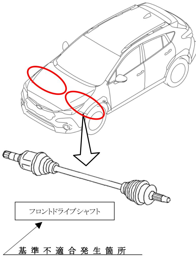
フロントドライブシャフトにおいて、製造工程における熱処理が不適切なため、アウターレースの表面に亀裂が発生し、強度が不足しているものがある。そのため、使用過程で亀裂が進展するとアウターレースが破損し動力伝達不良となり、最悪の場合、トランスファクラッチが損傷し、走行不能に至る。
