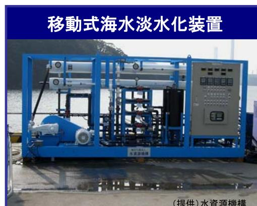
渴水時における水不足を補うために、海水淡水化装置を搬送可能な構造にしたものの
