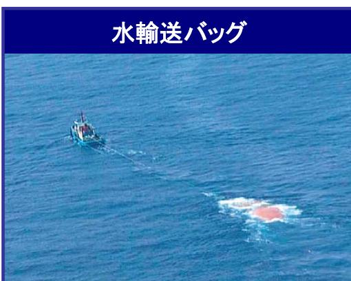
緊急時において、大量の水を水不足の地域へ機動的に移動させ、供給するため、経済産業省及び(独)水資源機構などが、水バッグによる海上水輸送試験を実施
