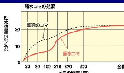
蛇口に取り付けるだけで、台所・洗面所のように流し洗いをするところでは、1分間で約6L節約可能。東京都水道局では無料配布。
