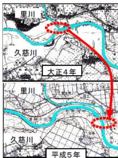
図 4-8 里川合流部改修工事による河道の変遷
