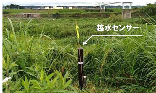
図 9-7 越水・決壊センサーの開発・整備イメージ図
