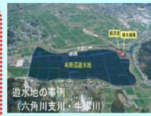
貯留・遊水機能の確保により、約19百万m<sup>3</sup>の容量を確保
