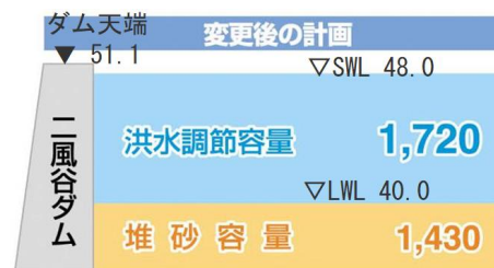
二風谷ダム容量配分図（変更後）
