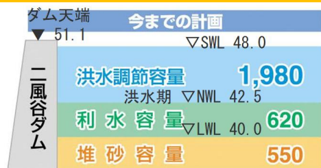
二風谷ダム容量配分図（変更前）
