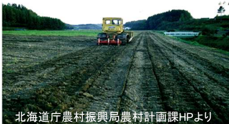
北海道庁農村振興局農村計画課HPより 農地の心土破碎状況
