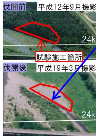
樹木伐開と合わせ、河原再生の試験施工(切り下げ)を実施。伐開後の状況をモニタリング中
