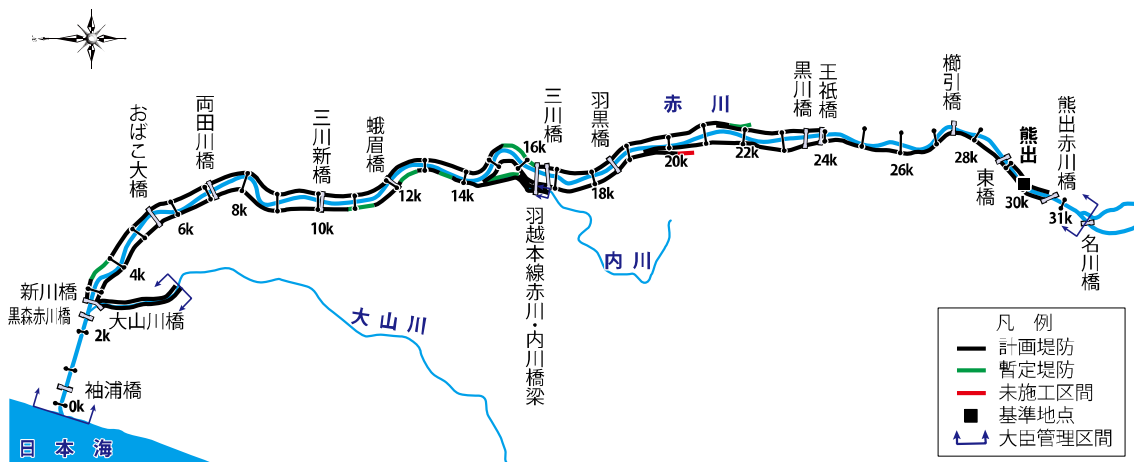
図 9-3 赤川直轄管理区間 堤防整備状況図（ダム区間を除く）
