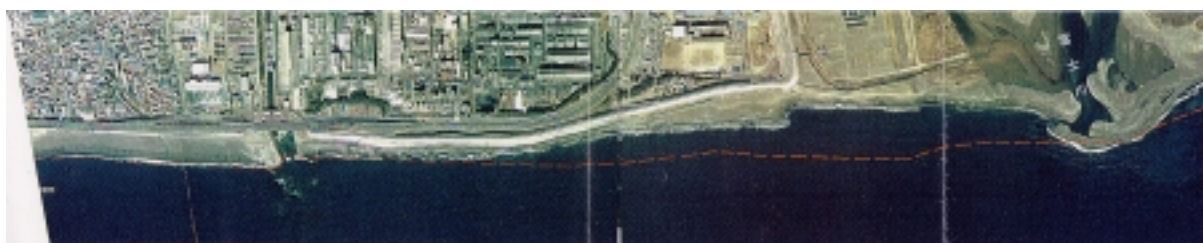
海岸浸食(平成8年):富士海岸(蒲原) (赤色の破線は昭和22年の海岸線)最大340m後退している。
