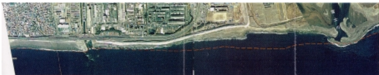
▲海岸浸食（平成8年）：富士海岸（蒲原） （赤色の破線は昭和22年の海岸線）最大340m後退している。
