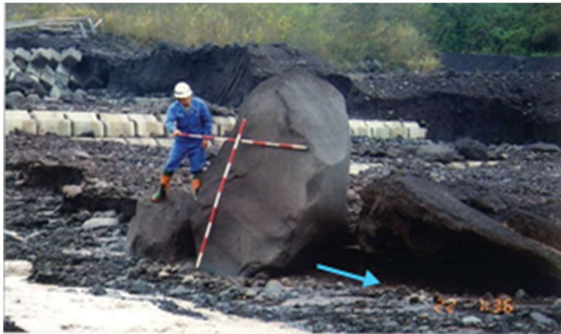
図 2-3 大沢川遊砂地に流下した 2m を超える巨石
