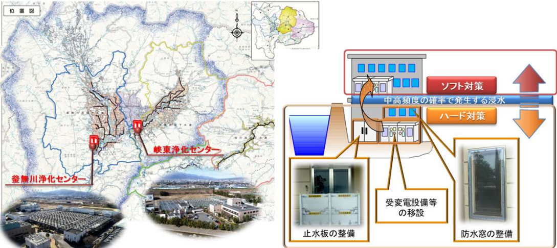
下水道施設の浸水対策（山梨県）
