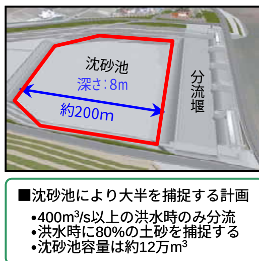
図 5.1.3 沈砂池による土砂流入対策
