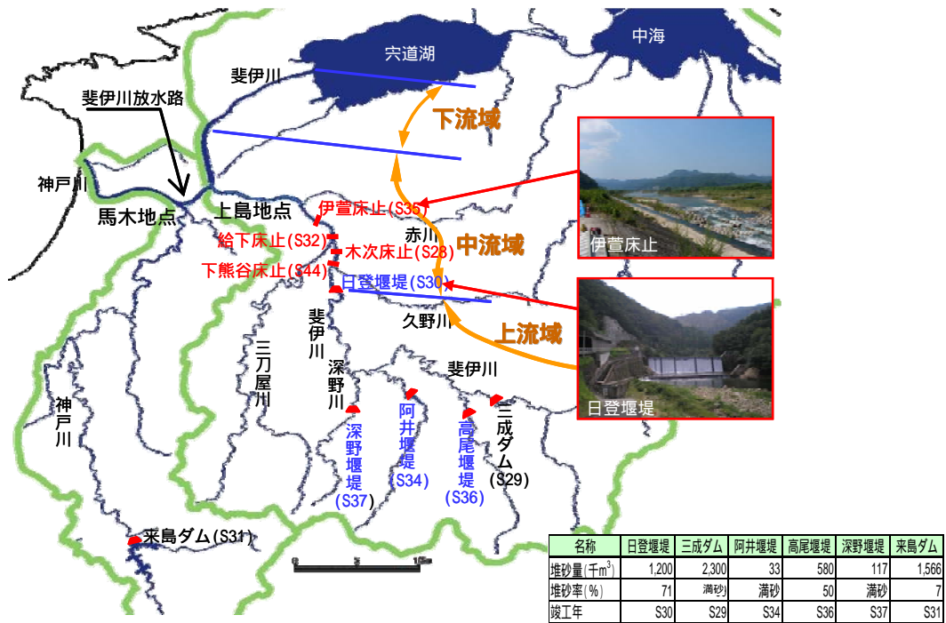
図 8.3.3 砂防堰堤の堆砂の状況
