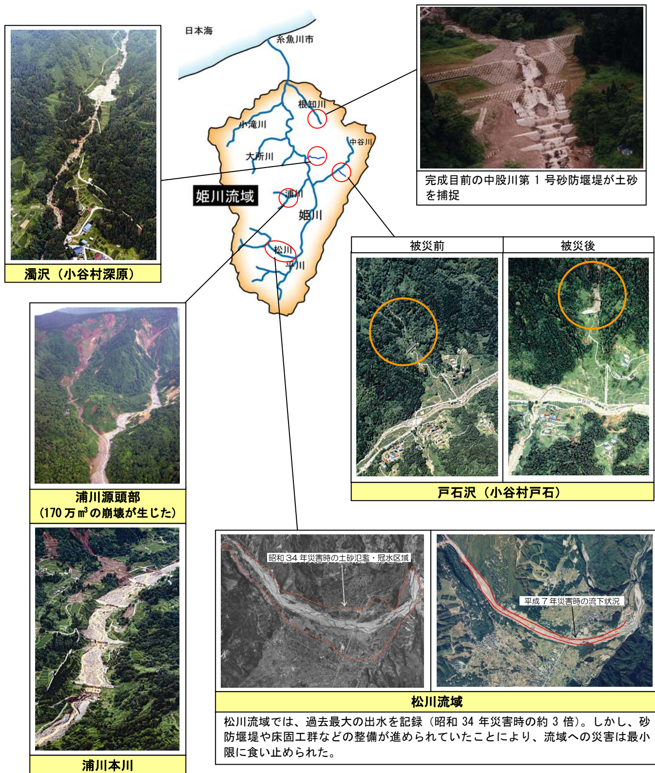
図 1 1 砂防堰堤の効果（平成7年7月洪水）
