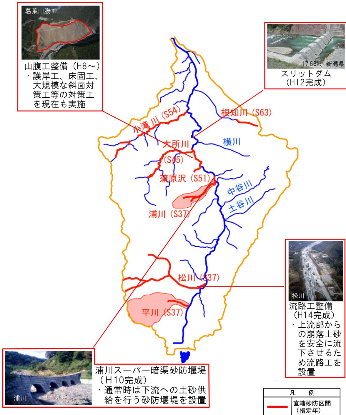
図 4-5 上流部での土砂対策
