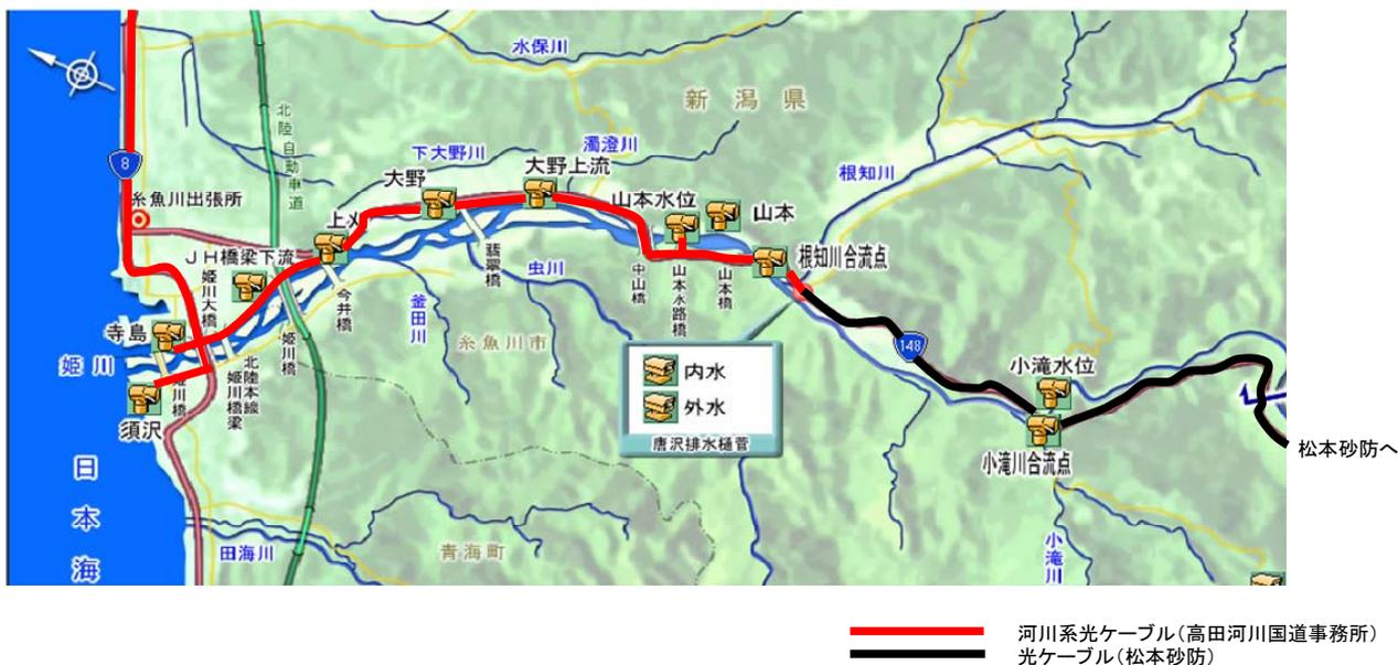
図 9-3 姫川水系 CCTV・光ファイバーケーブル配置図
