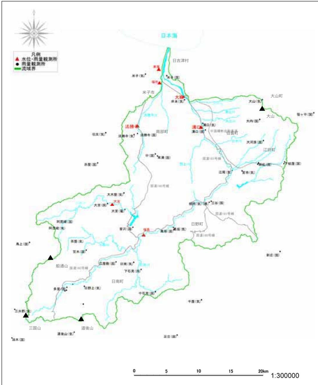
図 9.4.1 日野川水系の雨量・水位・流量観測所設置位置図
