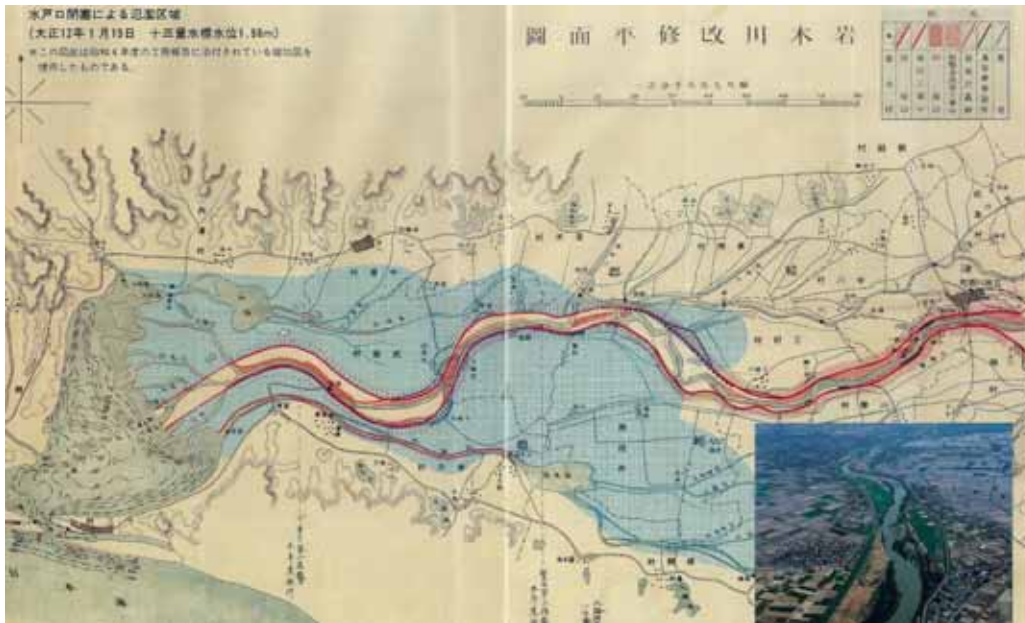
図 4-3 水戸口閉塞による氾濫区域
