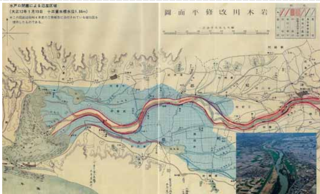
図 4-3 水戸口閉塞による氾濫区域
