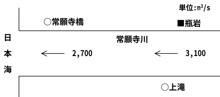
図 4-2-2 計画高水流量図 (昭和 43 年 2 月 7 日策定)
