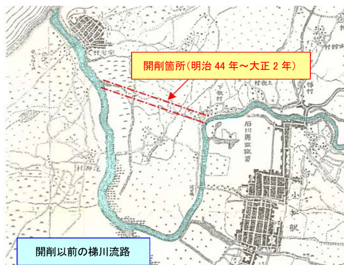
図 4-10 下牧地先と鶴ヶ島地先の「川切り」
