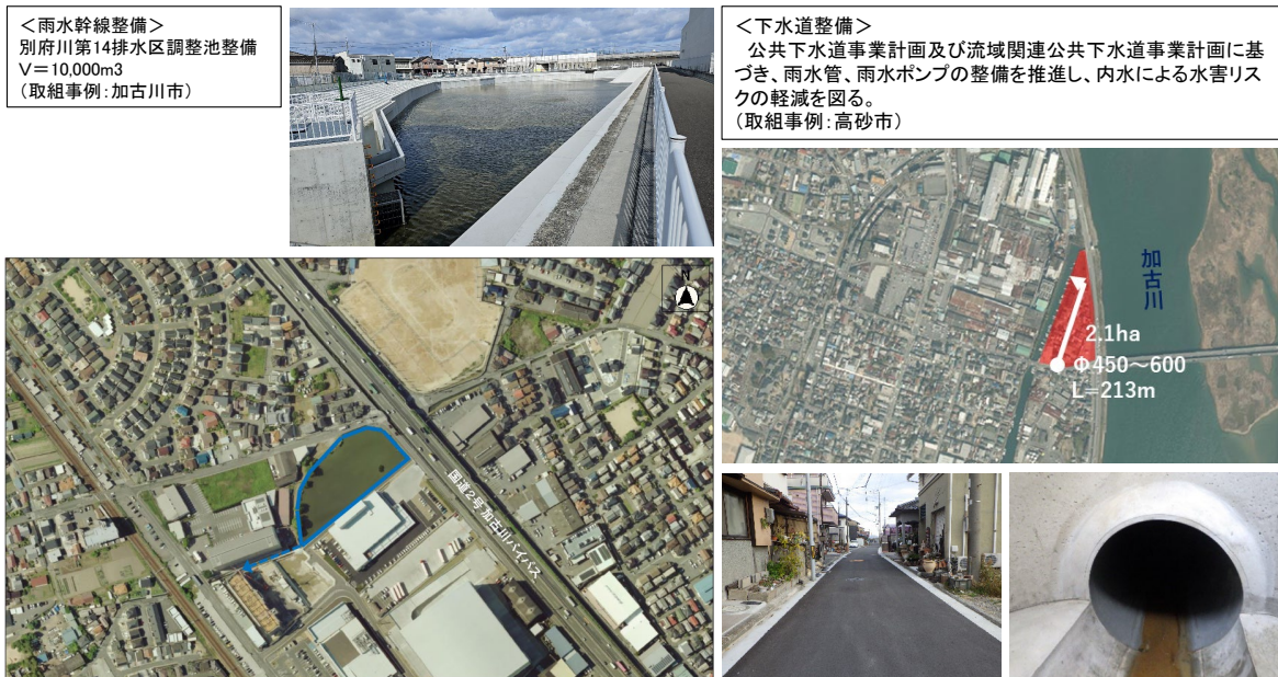
図－4.3.4 雨水幹線整備工事事例（加古川市、高砂市）
