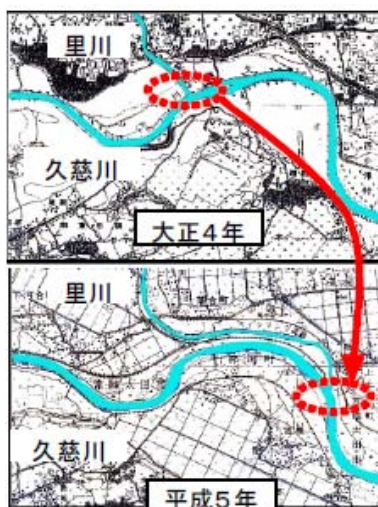
図 4-6 里川合流部改修工事による河道の変遷
