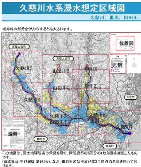
図 9-3久慈川水系浸水想定区域図 (出典：常陸河川国道事務所HP)
