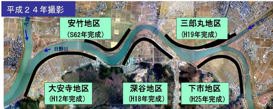
日野川五大引堤計画平面図
