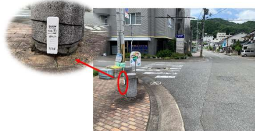
ワンコイン浸水センサ(増水時)
