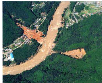
滝谷地区の斜面崩壊
