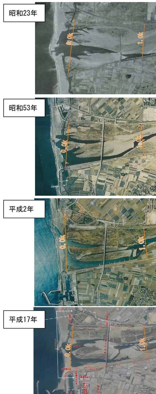
図 8.4.1 河口砂州の形状の経年変化
