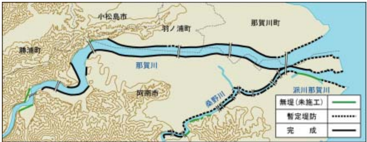
図4 - 5 現在の改修状況
