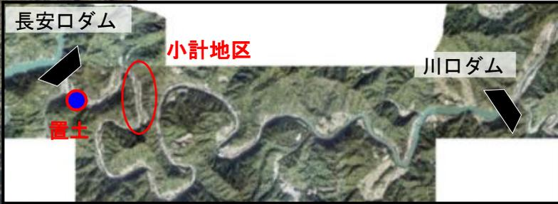
○ 長安ロダムでは、堆積土砂を下流に還元している。その結果、川口ダム上流区間（長安ロダム下流～川口ダム貯水池上流）では、土砂還元に伴い河床材料の粗粒化が解消され、砂礫の増加により瀬と淵が多様に分布する河道に変化するとともに、魚類種も多様化し、確認種数が増加することを確認した。今後は川口ダム下流への通砂対策も検討していく。
