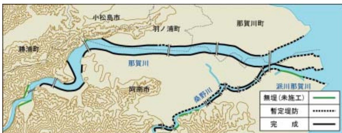
図4-5 現在の改修状況
