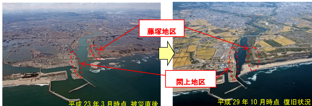
図 4-3-3 津波によって崩壊した堤防及び堤防復旧状況（右岸：閑上地区、左岸：藤塚地区）
