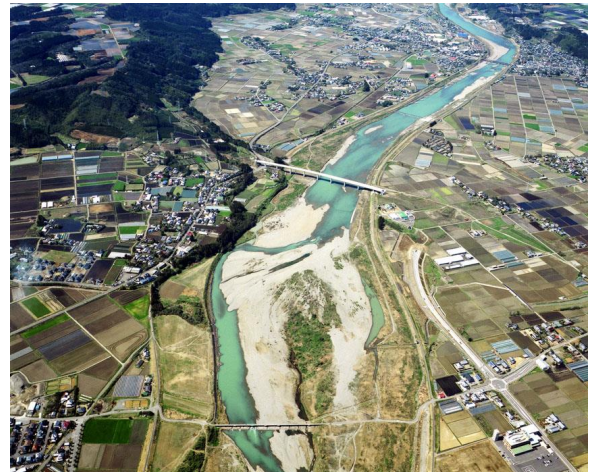
【小丸川中流部（高城橋下流付近：7.6km）】 河道は大きく広がり、緩やかに流下している。 広い高水敷は採草地として利用されている。
