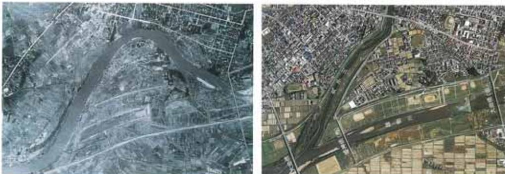
昭和 42 年度以降は、高水敷掘削、旧川締切堤防、護岸工事のほか附帯工事、補償工事の完成に多大の努力がなされ、昭和 44 年 10 月 31 日をもって工事はすべて完成した。大曲捷水路工事は、着手以来、実に 16 年の歳月と、総事業費約 19.6 億円(S60 年換算約 80 億円)の巨費を投じ、掘削土量約 180 万 m<sup>3</sup>、築堤土量約 101 万 m<sup>3</sup>、護岸延長約 6.5 km、帯工、橋梁各 1 ケ所、揚水施設 2 ケ所、樋管 13 ケ所を完工した大事業であった。
