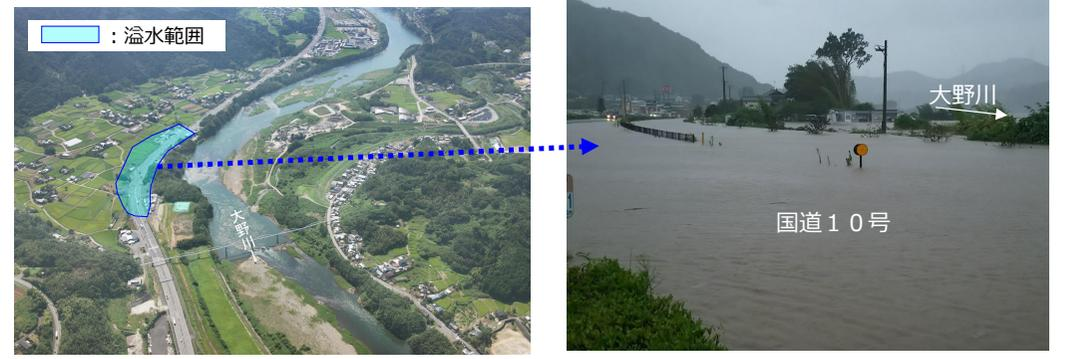
○ H29. 9洪水では現行計画高水流量9,500m<sup>3</sup>/sを上回る9,981m<sup>3</sup>/sを観測し、概ね8kから16k区間において計画高水位の超過を確認。
